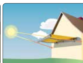
Soleil bas par ex. façade orientée ouest
