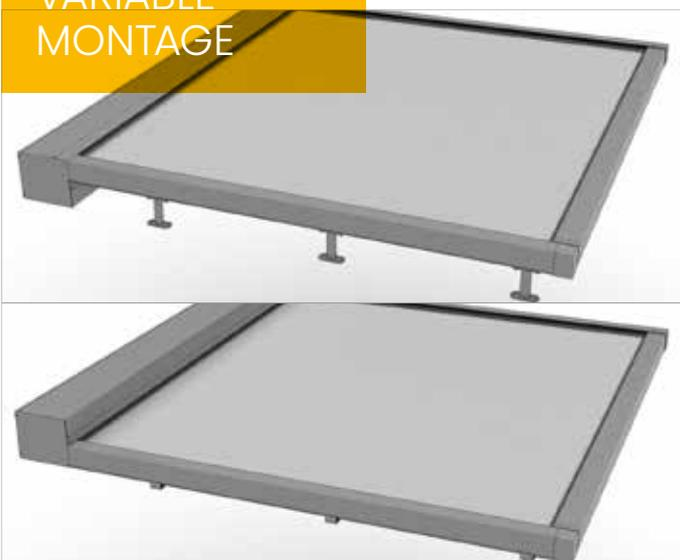
Variabel einsetzbar - Ein Kasten, zwei verschiedene Positionen. Kasten nach unten bzw. Kasten nach oben mit verschiedenen Montagemöglichkeiten wie Distanzkonsole, U-Distanzkonsole, Winkeldistanzkonsole, Leibungswinkel und Klippkonsole.
