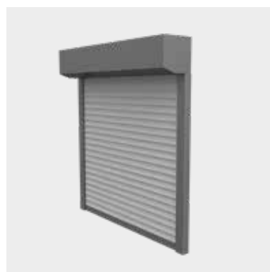
VOKA 120, 220 Cassonetto esterno in alluminio estruso (120) o profilato (220) Larghezza max. 3800 mm Altezza max. 2800 mm
